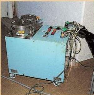
樹脂塗料を脈動空気流により、パイプ内部に均一な塗膜を形成する2回ライニング。
