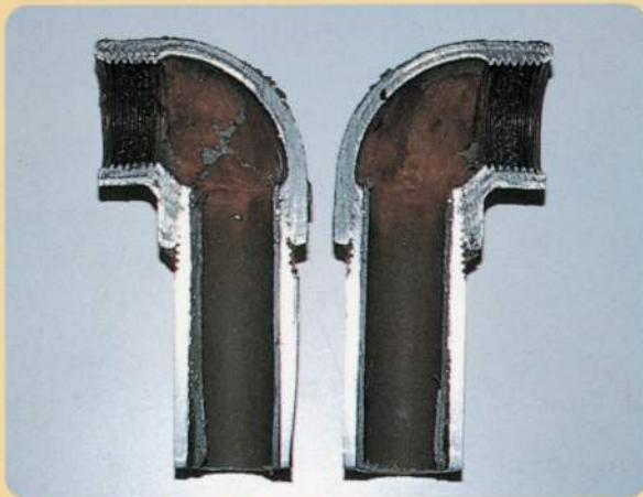
●サンプリングによる管のサビの測定。
