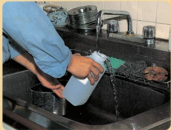
●水道法に基づく水質検査のためのサンプリング。
