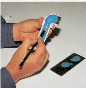
自然乾燥後、塗膜が一定の硬度になっているかをチェックします。
